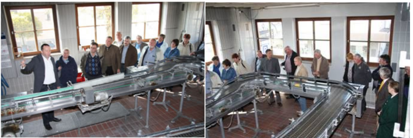
In der Flaschenabfüllung. Beschreibung im Schnelldurchlauf: Palette mit Leergut, Flaschen aus Kiste, Flaschen waschen, Kisten waschen, Flaschen füllen, Flaschen verschließen, Flaschen in saubere Kiste, Kisten auf Palette, Palette in Lager, fertig
